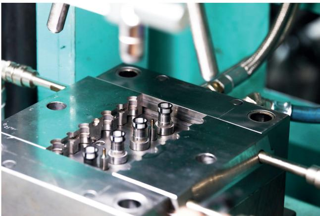
**Mikroteile:** Zu den Kompetenzen von Stolz & Seng gehören die Herstellung von Mikroteilen ab 2 mg sowie ab einer Wanddicke von 0,3 mm ebenso wie Bauteile aus hochtechnischen Kunststoffen, das Umspritzen von Metallgewebe und die Herstellung von Filtern und Sieben ©VDWF
