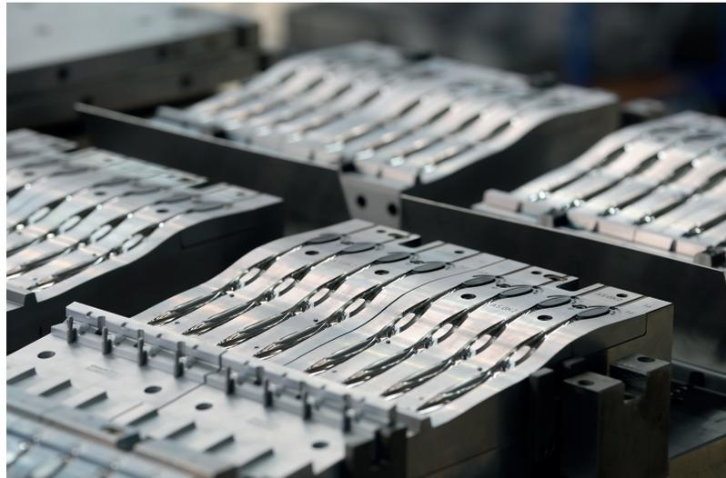
**Das Zahnbürstenwerkzeug** »Z.Platform line« von Zahoransky besteht aus einer Stammform und separaten Formeinsätzen. Für ein neues Modell müssen nur neue Kavitäten für den Zahnbürstengriff und -kopf hergestellt werden © VDWF
